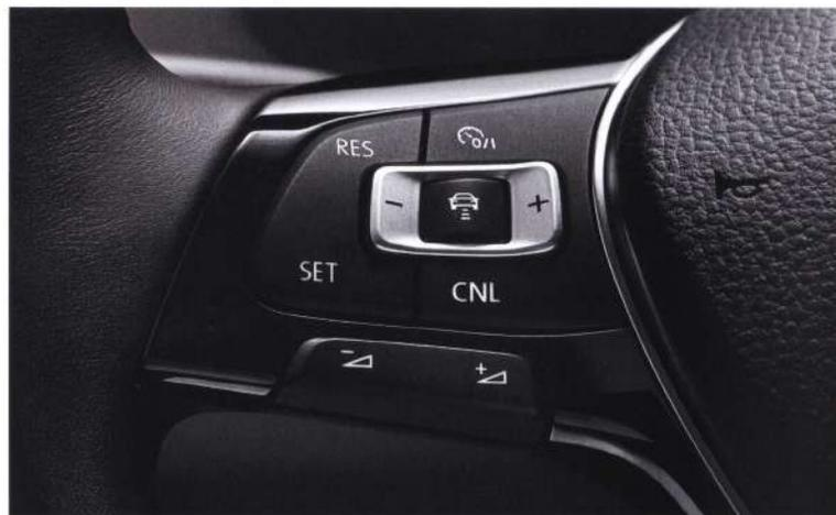
Die automatische Distanzregelung ACC mit Umfeldbeobachtungssystem „Front Assist“ und City-Notbremsfunktion passt Ihre Geschwindigkeit selbst in der Stadt oder bei stockendem Verkehr der des vorausfahrenden Fahrzeugs an, hält den gewählten Abstand ein, warnt vor zu schneller Annäherung und kann im Notfall helfen, schneller zu bremsen.
