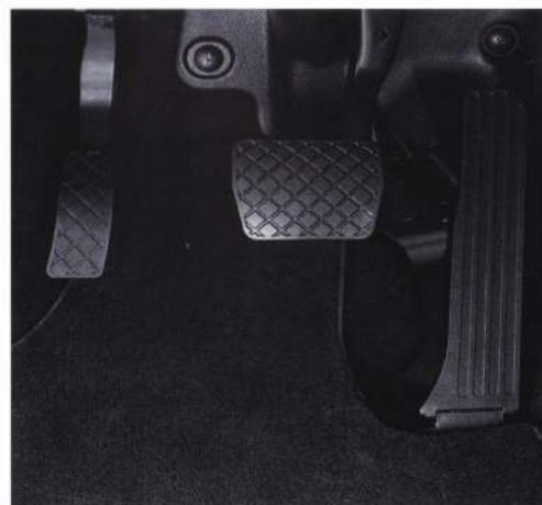
Beim elektronischen Linksgas ist das rechte Gaspedal automatisch deaktiviert und kann per Schalter wieder in Betrieb genommen werden. Der Betriebszustand ist am Schalter in der Mittelkonsole ablesbar.
